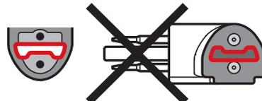
3. Introdurre il connettore 90° dritto nel primo profilo di contatto. Premerlo fortemente contro il profilo di contatto finché lo spazio tra connettore e profilo di contatto sparisce.
