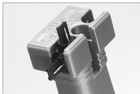
2. Verificare se il primo profilo di contatto e il connettore 90° sono orientati allo stesso modo.
