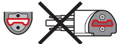
3. Introduisez le connecteur à 90° de manière rectiligne dans le premier profilé de contact. Enfoncez-le jusqu'à ce qu'il n'y ait plus aucun jeu entre les deux pièces.
