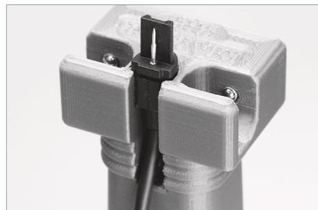
2. Vérifiez si le profilé de contact et l'embout sont bien alignés.
