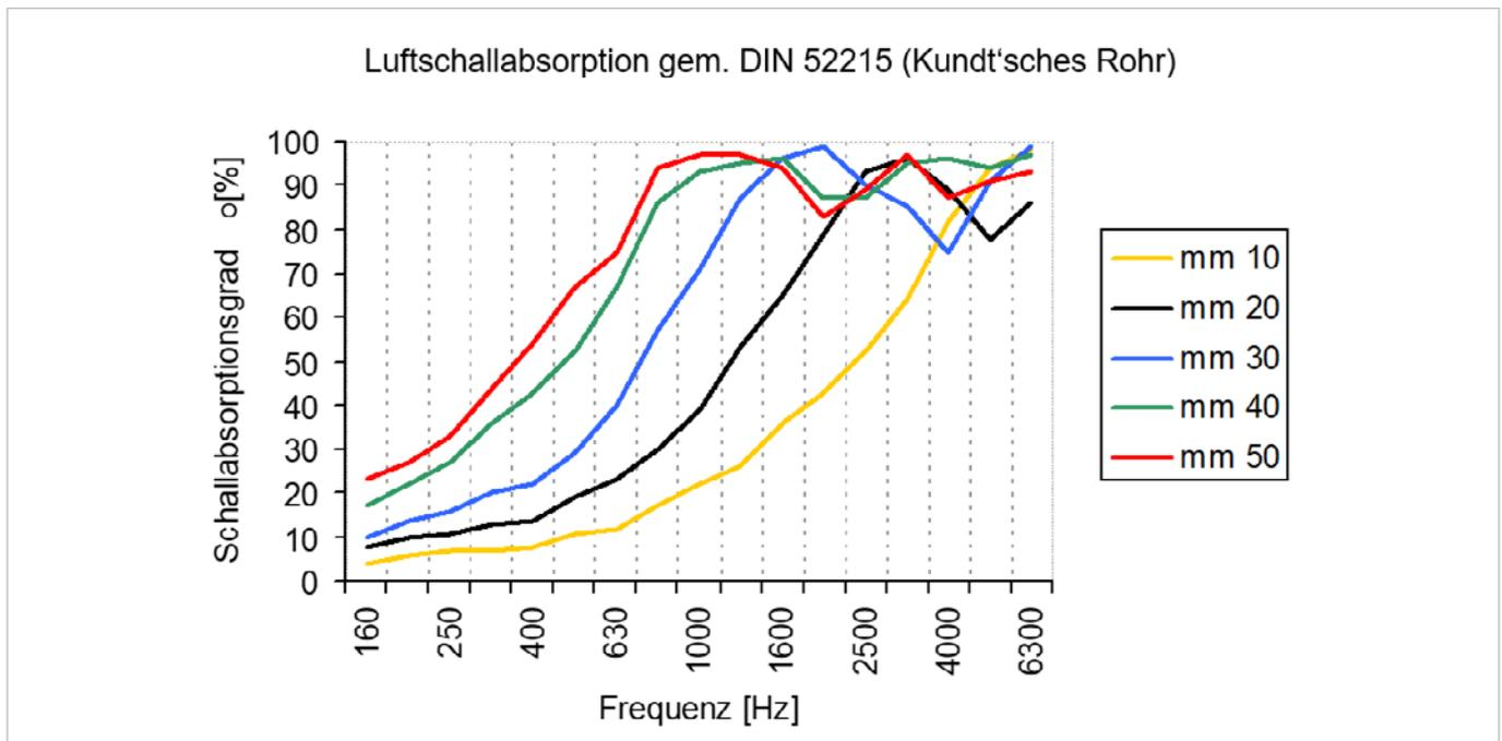
Die Oberflächenbearbeitung von PUR-Ester- oder Ether-Schaumstoffen definiert deren akustische Wirksamkeit im jeweils erforderlichen Frequenzbereich und passt den Schaumstoff an die physikalischen Belastungen seines Einsatzbereiches an. Die Verwendung von Ester-Schaumstoffen ist für den Einsatz in trockener Umgebung geeignet, Ether-Schaumstoffe eignen sich für den Einsatz in feuchter Umgebung.
