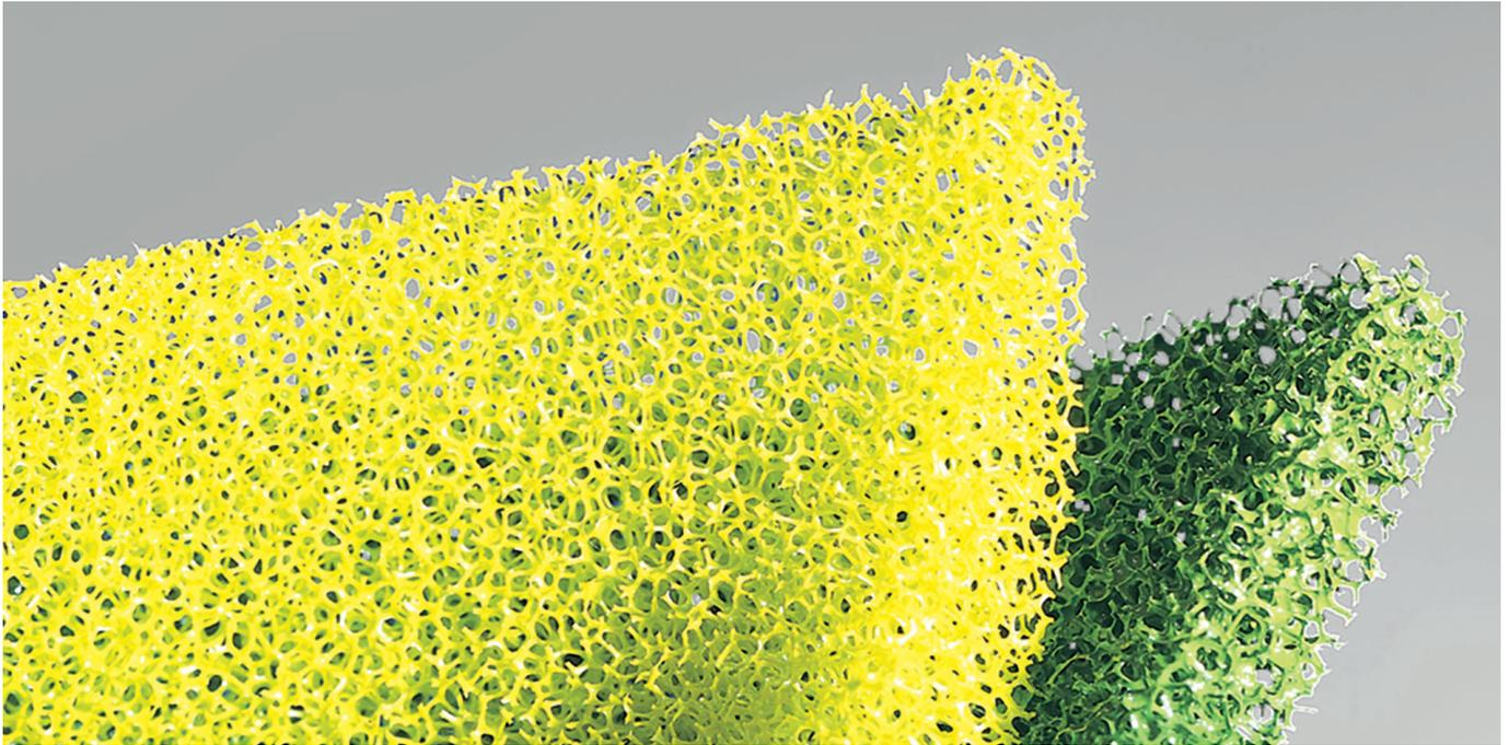
Mittels Foulardieren können verschiedene Stoffe in Polyurethan-Weichschaumstoffe eingebracht und die physikalischen Eigenschaften des Schaumstoffes anwendungsspezifisch variiert werden. Dabei wird das Substrat im Tauchverfahren mit der Flotte getränkt. Danach wird das ausgerüstete Substrat durch ein Walzenpaar geleitet, um den Flottenüberschuss auf ein genau definiertes Maß abzuquetschen.
