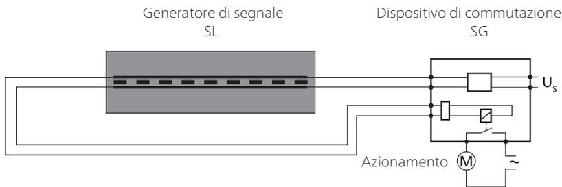
La tecnica a 4 conduttori può essere utilizzata soltanto con il dispositivo di commutazione SG EFS 104/4L.
