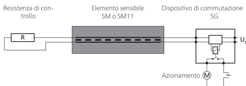
La resistenza di controllo deve essere adattata al dispositivo di commutazione. Standard è 8k $\Omega$ .
