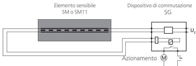
La tecnica a 4 fili può essere utilizzata solo con il dispositivo di commutazione SG-EFS 104/4L.
