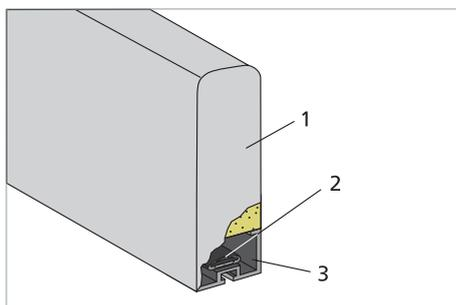
Il bumper di sicurezza è composto da un elemento sensibile (da 1 a 3) (1) schiuma con rivestimento, (2) elemento di commutazione, (3) profilo di supporto in alluminio e un dispositivo di commutazione SG di valutazione.
