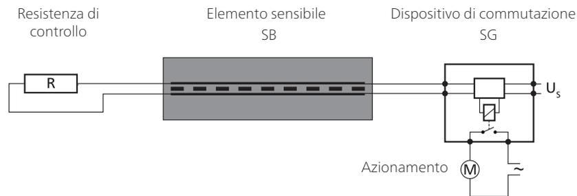
La resistenza di controllo deve essere adattata al dispositivo di commutazione. Standard è 8k $\Omega$ .
