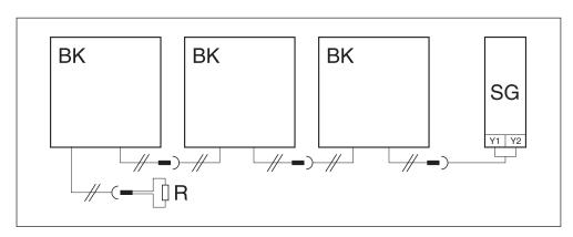
Verdrahtung der Schaltmatten BK für die 2-Leiter-Technik mit optionalem Endstecker, in dem der Widerstand R integriert ist.
