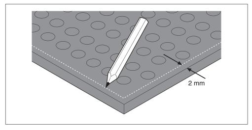
An diesen Markierungen werden die Rampenschienen ausgerichtet, damit ein Luftspalt von 3 mm Breite zwischen Schaltmattenkante und Anschlagsteg (3) der Rampenschienen bleibt.
