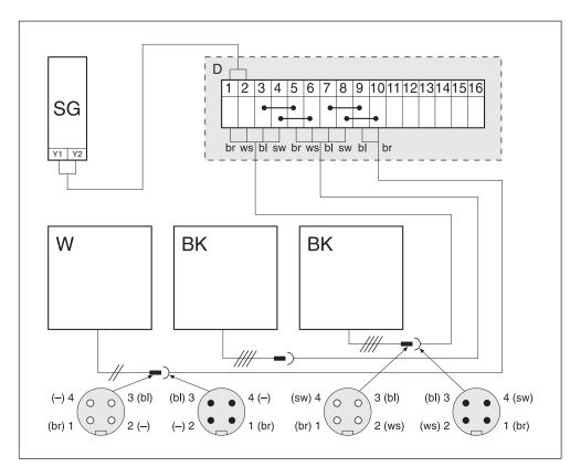
Verdrahtung der Schaltmatten W und BK für die 2-Leiter-Technik über Unterverteilung
