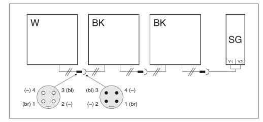
Verdrahtung der Schaltmatten W und BK für die 2-Leiter-Technik
