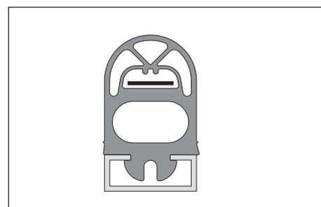
Anschließend zur Kontrolle des Sitzes das Gummiprofil auf der gesamten Länge durchkneten.
