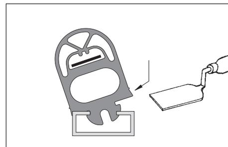
3. Mit kräftigem Daumendruck oder mit Hilfe einer Kelle die andere Längsseite des GP-Fußes nach und nach einclippen.
