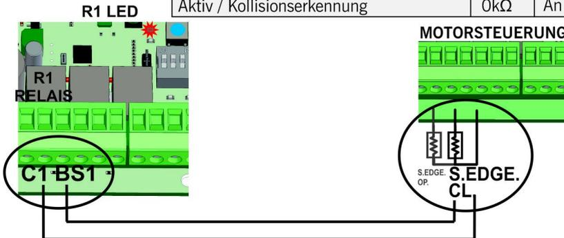
Das Gerät kann an die Motorsteuerung angeschlossen werden entweder über den Eingang für die 8k2 Sicherheitsschaltleiste oder direkt über einen Öffnerkontakt-Sicherheitseingang, wie bei einer Lichtschranke oder einem STOP-Signal. Diese Anschlussmöglichkeit ist für die Ausgänge R1 und R2 vorhanden.
