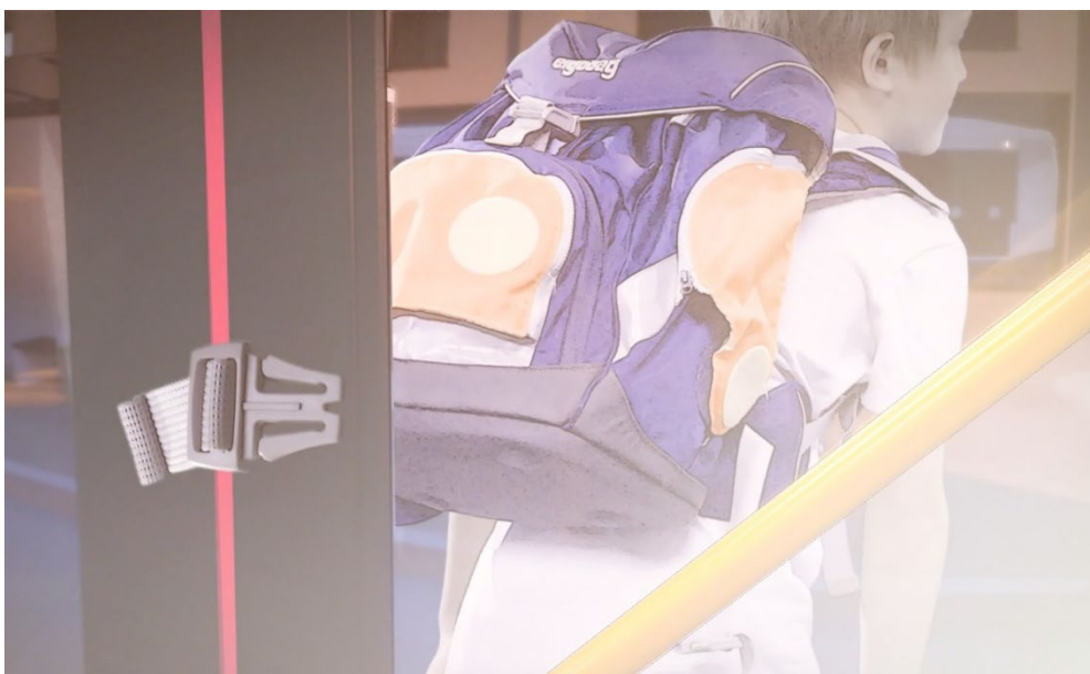
Gefahr gebannt: Die Mitschleiferkennung von Mayser erfasst auch kleine Objekte wie Rucksackträger
