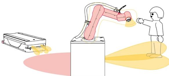
Verschiedene Sicherheitskomponenten wie sicherer Ultraschall, Flächensensoren, taktiler und kapazitiver Kollisionsschutz sowie Softcover für eine sichere Mensch-Roboter-Kollaboration (MRK)
