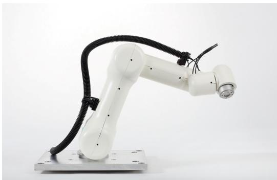
Kollisionsschutz von Mayser: Taktile und kapazitive Arm- und Gelenkabsicherungen schützen den Menschen bei bzw. vor Berührung des Roboters.
