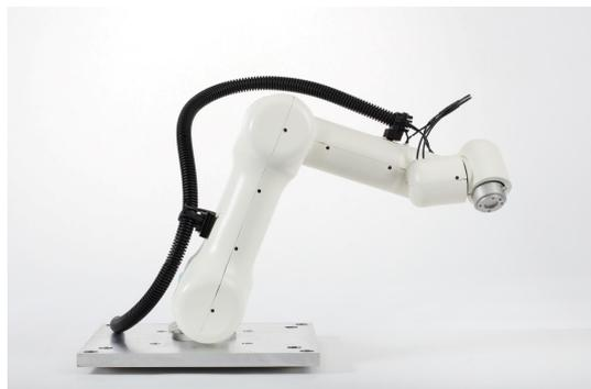
3D Kollisionsschutz von Mayser: taktile und kapazitive Arm- und Gelenkabsicherungen schützen den Menschen bei bzw. vor Berührung des Roboters.
