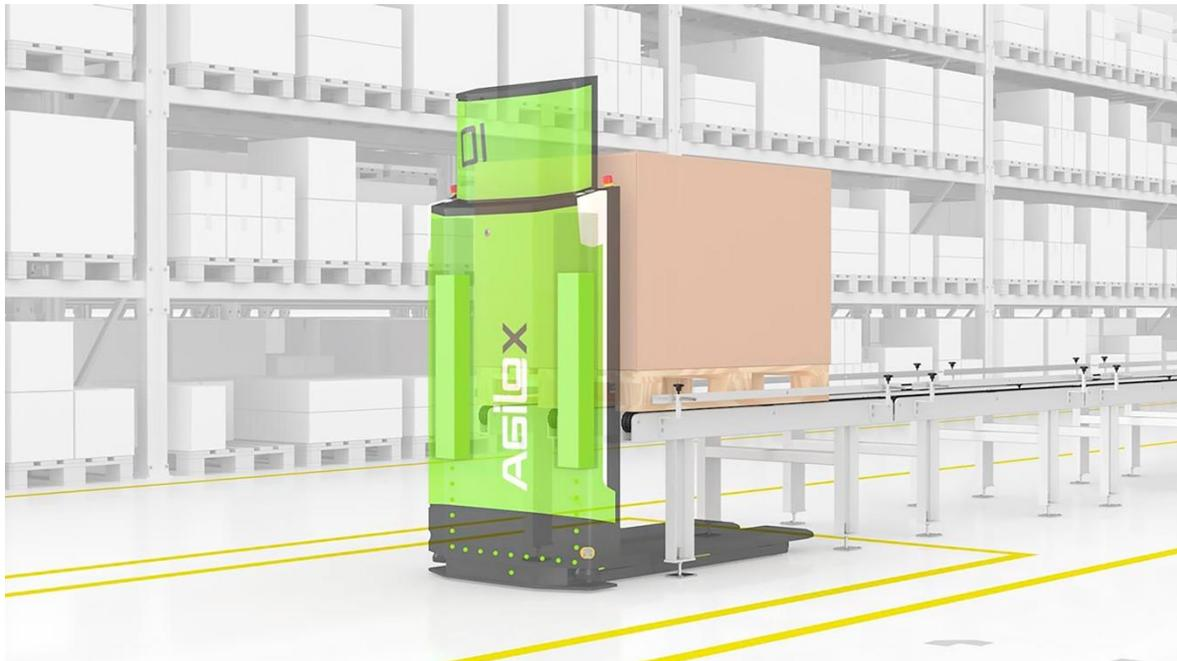
Agilox Transportsysteme manövrieren dank Ultraschallsensoren störungsfrei auf engstem Raum
