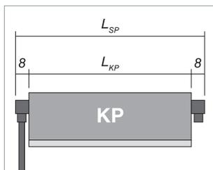
1. Messen Sie das Kontaktprofil (KP) auf Länge ab und markieren Sie die Schnittstelle. Es gilt:
