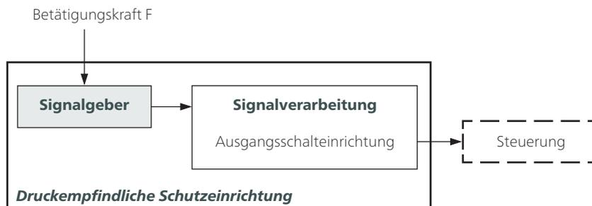
Wer Signalgeber mit Schaltgeräten kombiniert und damit druckempfindliche Schutzeinrichtungen inverkehrbringt, sollte die grundlegenden Anforderungen nach ISO 13856 berücksichtigen.
