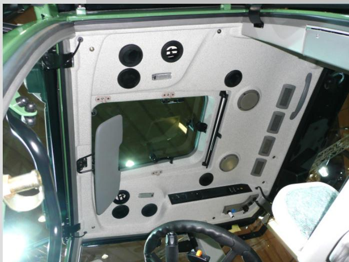
Selbsttragende Formteile, Präge- und Stanzteile aus Polyurethan- Weichschaum oder Vliesstoffen werden als INDUMONT-Interieurteile im Fahrzeugbau eingesetzt. Eine große Auswahl an Träger- und Dekormaterialien ist die Basis für ein breites Anwendungsspektrum. Kundenspezifische Produktentwicklungen für kleine und mittlere Serien erfüllen technische Anforderungen und individuelle Designwünsche.
