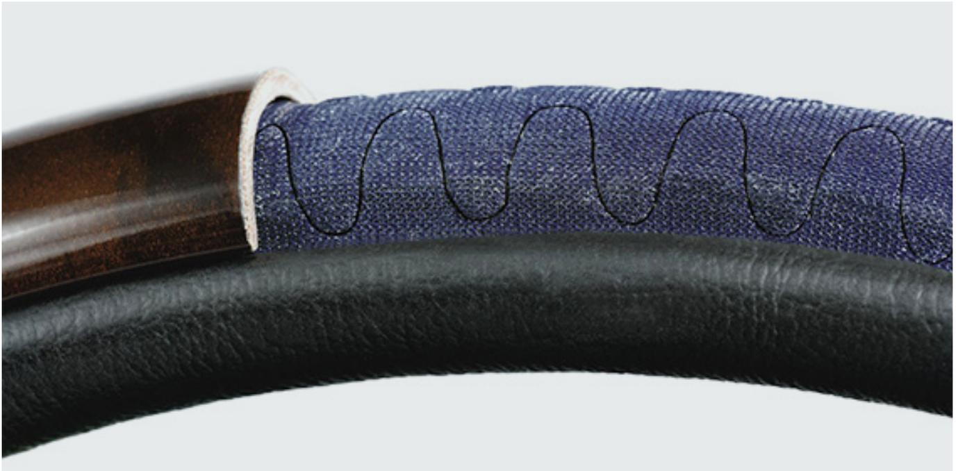
INDUCON® ist ein ausgleichendes Material mit einstellbarer Haptik und wird als Trägermaterial für Lenkradheizungen verwendet. Dabei steht im Fokus, dass die Heizlitze im lederkaschierten Lenkrad weder sichtbar noch spürbar ist. Darüber hinaus gewährleistet die glatte INDUCON®-Oberfläche einen wirtschaftlichen Klebereinsatz beim Kaschieren.
