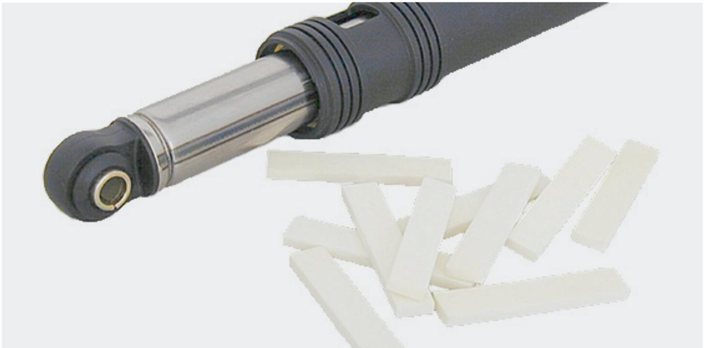
INDUCON® wird als Reibbelag oder Anschlagpuffer für Friktionsdämpfer eingesetzt. Durch die exakt steuerbare Härte des Werkstoffs ist die Reibkraft des Dämpfers in einem breiten Spektrum einstellbar. Die engen Dicken- und Gewichtstoleranzen des Materials ermöglichen einen schmalen Toleranzbereich des Fertigproduktes sowie optimalen Materialeinsatz.
