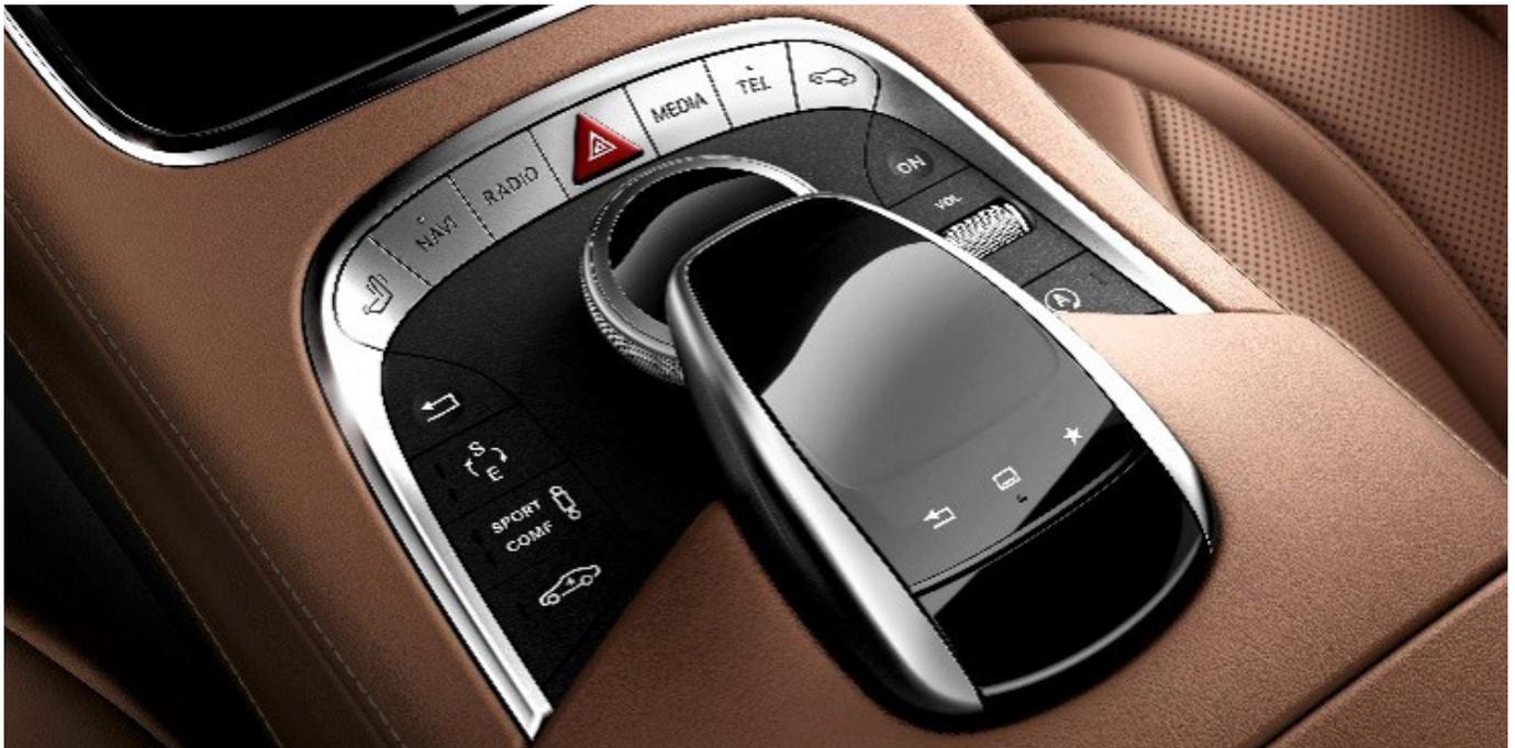
INDUCON® hat sehr gute Dämpfungseigenschaften, enge Dickentoleranzen und steuerbare Härte. Eigenschaften, welche die Haptik des Touchpads entscheiden prägend und somit dem Fahrer ein Bedienen mittels intuitiven Fingergesten erlaubt.
