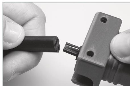
4. Entnehmen Sie das Endstück aus der Steckhilfe SH4.
