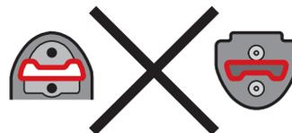
3. Führen Sie das Endstück gerade in das Kontaktprofil ein. Drücken Sie es fest gegen das Kontaktprofil, bis der Lufspalt zwischen Endstück und Kontaktprofil verschwindet.
