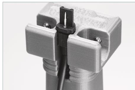
2. Prüfen Sie: Sind Kontaktprofil und Endstück gleich ausgerichtet?
