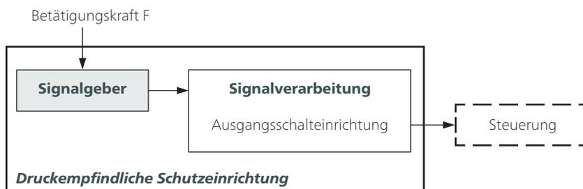
Wer Signalgeber mit Schaltgeräten kombiniert und damit druckempfindliche Schutzeinrichtungen inverkehrbringt, sollte die grundlegenden Anforderungen nach ISO 13856 berücksichtigen.
